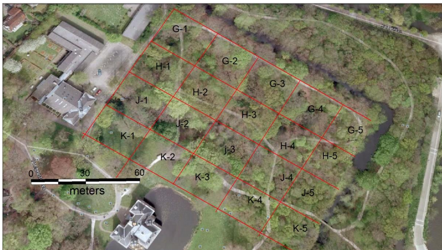
Afb. 3.1. Het meetsysteem voor het metaaldetectieonderzoek in het park Oud-Poelgeest, 2017.
